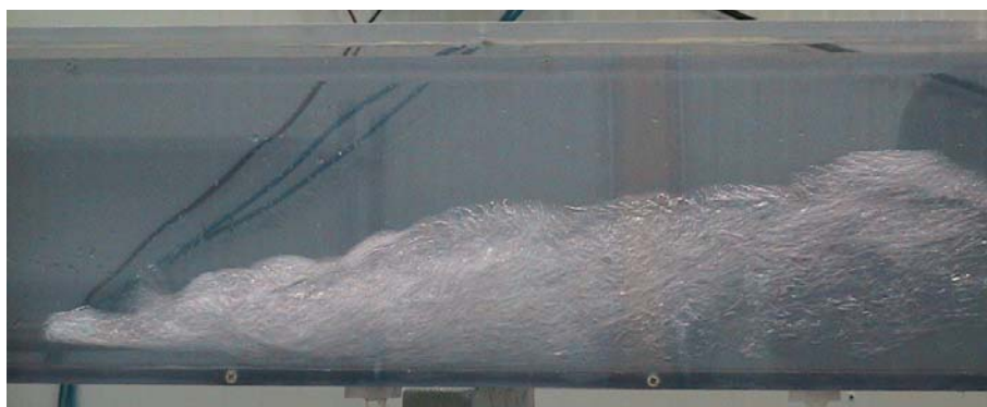
Figura 18: un risalto idraulico con passaggio da corrente veloce (a sinistra) a corrente lenta (a destra)
