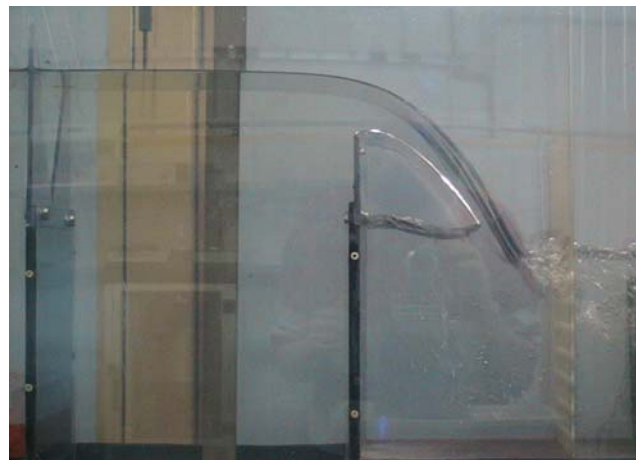
Figura 23: a sinistra, schema di stramazzo in parete sottile, a destra, sua realizzazione in laboratorio
